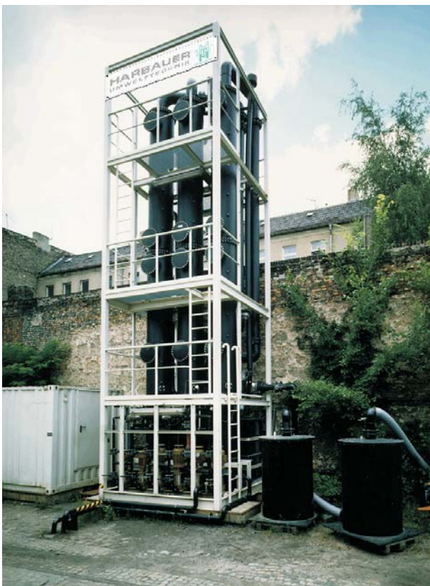
Dreistufige Desorptionskolonne mit nachgeschalteter Luftaktivkohle in Berlin Oberschöneweide
